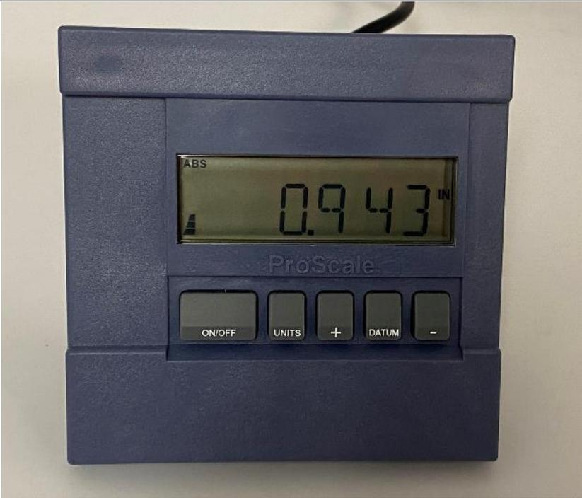
¼ DIN size Panel Mount LCD Readout
